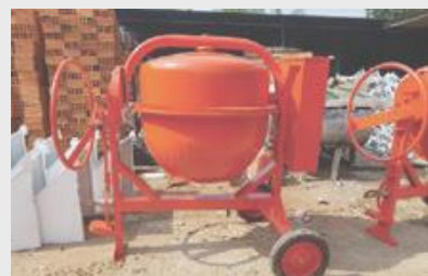
Máy trộn bê tông
